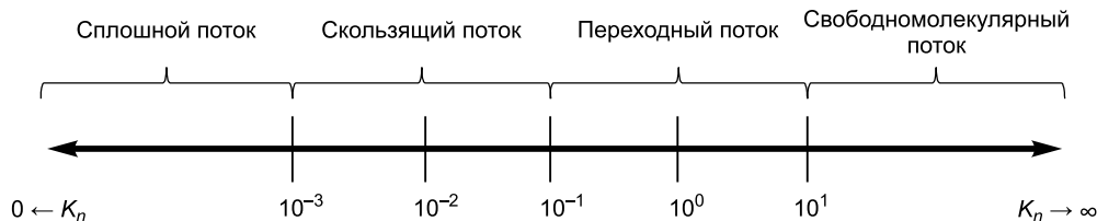
Рис. 1. Ранжирование переходных режимов течения, основанное на числе Кнудсена Kn , равного отношению длины свободного пробега к характерному размеру задачи.
