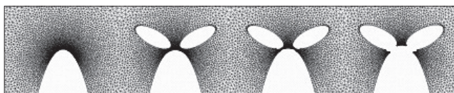
Рис. 6. Рост трещины и появление дополнительных пор.
